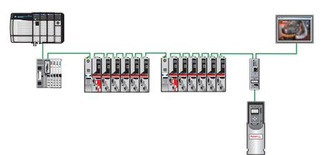
线性 Ethernet 段极大地延伸了应用的广度。无需从将电缆从每个设备背部引入到中央交换机。
