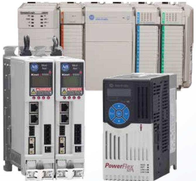
对于注重简单速度控制和精确电机功能的应用而言，将交流变频器和伺服驱动器配合使用是比较合理的解决方案。PowerFlex 527 交流变频器管理简单的速度控制，而 Kinetix 伺服驱动器处理较为精确的速度、扭矩和位置控制等电机控制操作。
