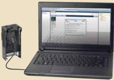
凭借 MainsFree™ 编程功能，您可以通过 USB 连接将配置文件上传和下载到 PowerFlex 525 和 PowerFlex 523 变频器控制模块。
