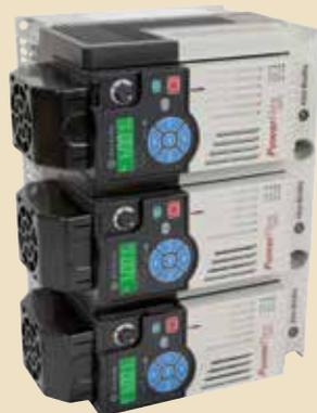
上述三种变频器设计灵活，均支持垂直安装或水平安装，而且或垂直或水平都可以并排安装。水平安装时需要使用控制模块风扇套件。
